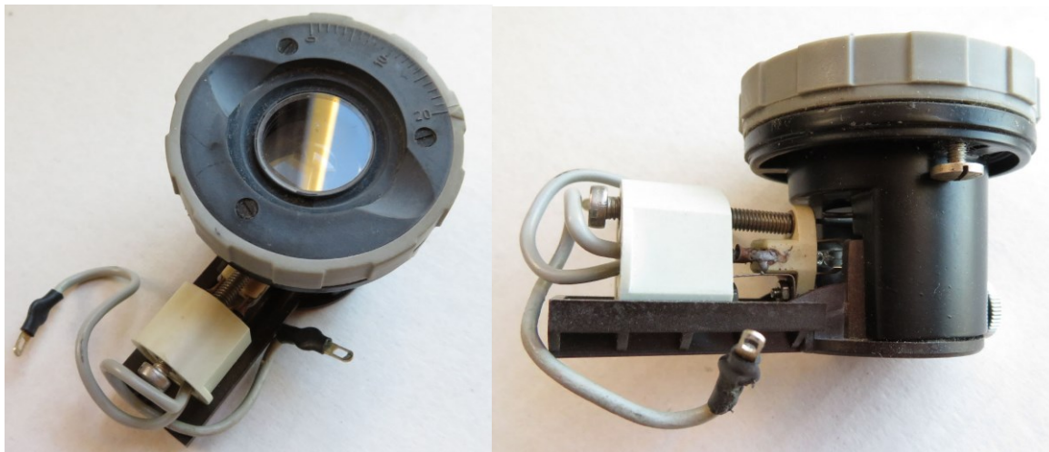
Fig. 1,2: illuminatore originale + blocco diaframma separato dalla base del microscopio
